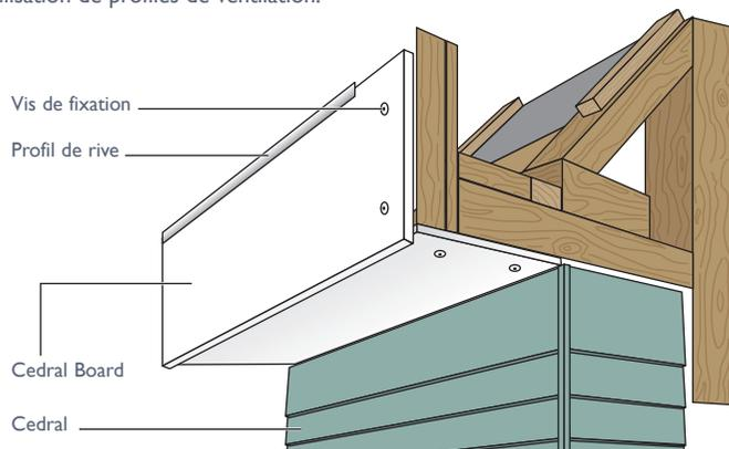
Pour les revêtements de rives de toiture, les bandes de rive peuvent être fixées sur des lattes d'appui alignées pour autant que la ventilation soit assurée par la pose :
