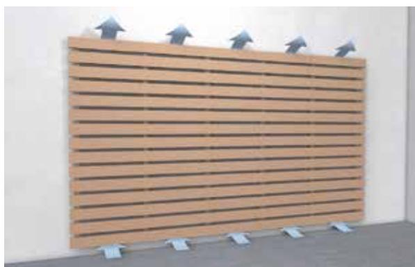
L'espace vide de ventilation doit être d'au minimum 20 mm et il est proscrit de le réduire. Les orifices d'entrée et de sortie d'air doivent présenter sur toute leur longueur une largeur d'au moins 20 mm.
