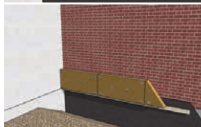
La pose se fait à coupe de pierre et bord à bord pour les panneaux à bords droits.
