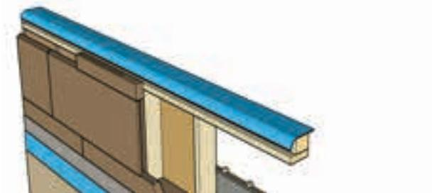
Une bande de pare-vapeur est mise en œuvre sur la sablière avant la pose des chevrons pour assurer la continuité de la fonction pare-vapeur/étanchéité à l'air avec le mur.
